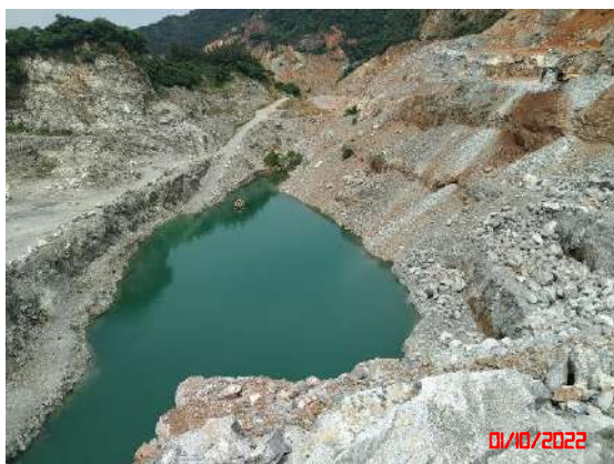
รูปที่ 22 บ่อรับน้ำ (Sump) ป่อเหมือง
